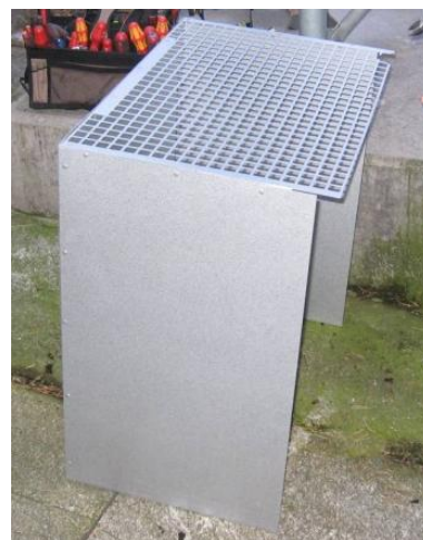
Vinkellister används för sammansättning av plåtarna
