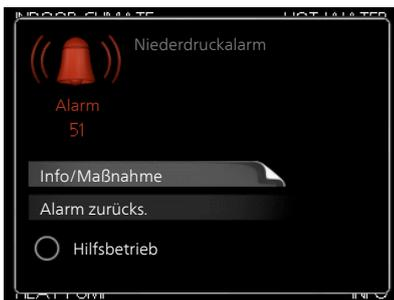
Bei einem Alarm ist eine Betriebsstörung aufgetreten. Die Statuslampe leuchtet dabei nicht mehr durchgehend grün, sondern durchgehend rot. Außerdem erscheint im Informationsfenster ein Alarmglockensymbol.
