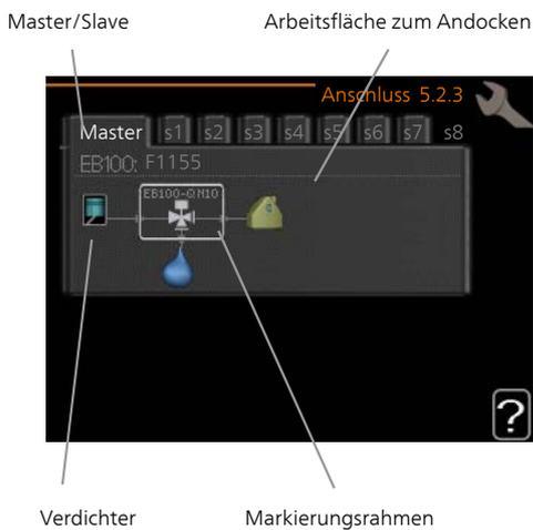
**Master/Slave:** Hier stellen Sie ein, für welche Wärmepumpe die Anschlusseinstellung vorgenommen werden soll (bei einer einzelnen Wärmepumpe im System wird nur der Master angezeigt).
